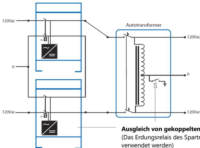
**Ausgleich von gekoppelten Wechselrichtern**
