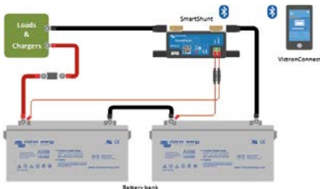
Messen des Mittelpunkts der Batteriebank
