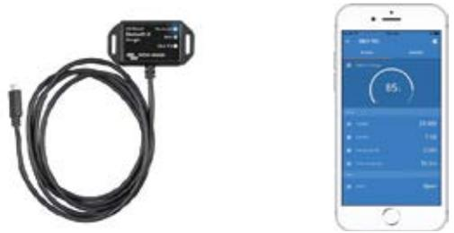
Mit dem energiesparenden VE.Direct zu Bluetooth Smart Dongle lassen sich Daten und Alarmer in Echtzeit auf Apple und Android Smartphones, auf Tablets, Macbooks sowie auf anderen Geräten anzeigen.
