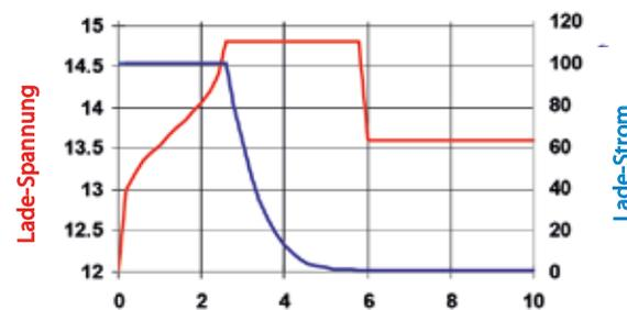
Bild 3: Dreistufen-Ladekennlinie
