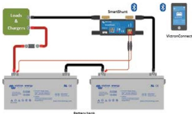
Messen des Mittelpunkts der Batteriebank
