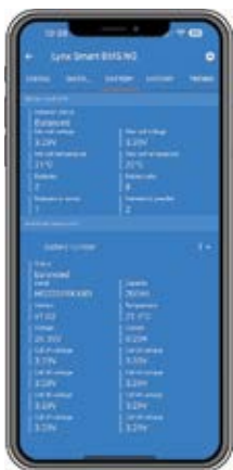
Vollständiger Überblick über alle Batteriedaten über VictronConnect (oder ein GX-Gerät und VRM)
